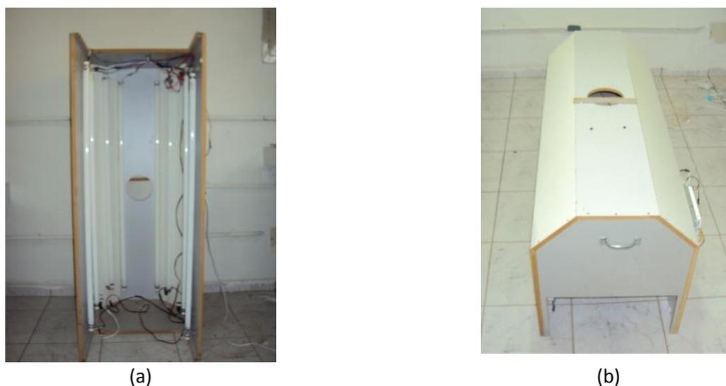
**Figura 1.** Câmara de luz uniforme utilizada na obtenção das imagens, vista interna (a) e vista externa (b)
