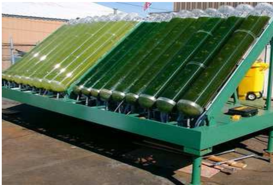
Figura 3. Produção de biodiesel através de fotobiorreatores fechados. Fonte: (6)
