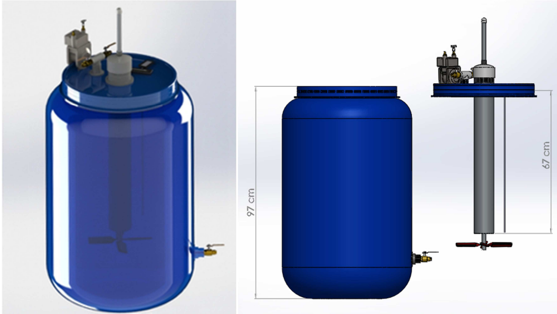
Figura 2. Esquema em 3D do biodigestor utilizando o software SolidWorks®Premium 2014. Desenho: Cesar Barretto Cristófoli.
